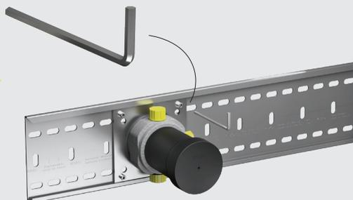
Con i perni filettati è possibile regolare la struttura base in maniera precisa affinché stia davanti alla parete perfettamente ad angolo retto. In caso di utilizzo della guida di montaggio, i perni filettati vengono utilizzati per il fissaggio dei moduli sulla guida.
