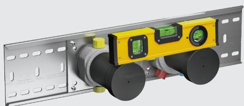
In tutti i moduli i tappi hanno lo stesso diametro in modo tale che possano essere utilizzati per la regolazione con la livella a bolla. In caso di utilizzo della guida di montaggio, la guida viene allineata. Le strutture base sono allineate automaticamente dopo l'aggancio della guida.
