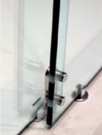
Guida applicata sulla seconda anta di cristallo mediante due viti. Questa guida ha la funzione di tenere la prima anta. Guida cilindrica a scomparsa in&out. Finitura di serie cromo lucido.
